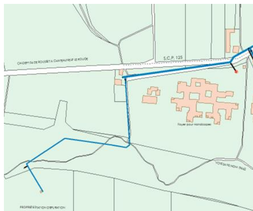
Source : Plan Local d'Urbanisme de la Commune de Rousset – 5b9 « Réseau collectif d'eau potable »
