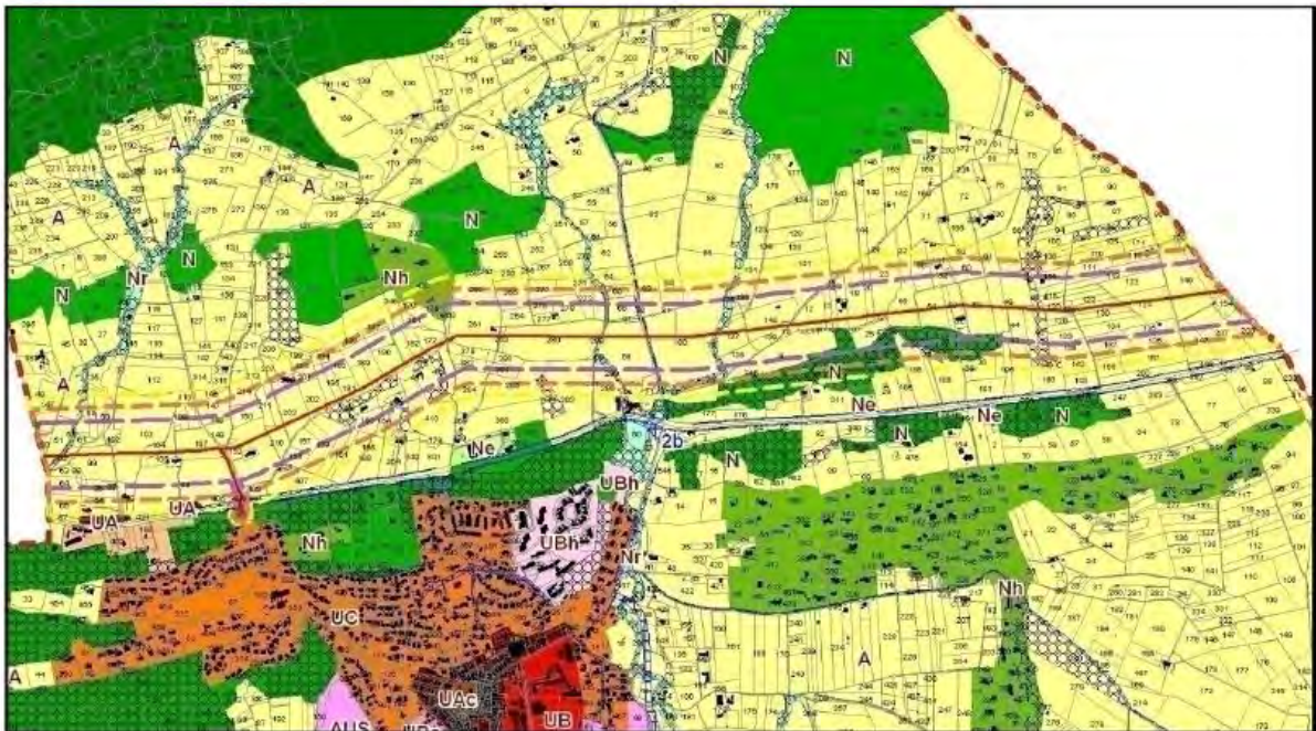
Extrait du règlement graphique du PLU : Impact de la servitude liée aux canalisations et au poste de transport GRT Gaz
